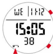
BATTERIA SCARICA (SOSTITUIRLA AL PIÙ PRESTO)
